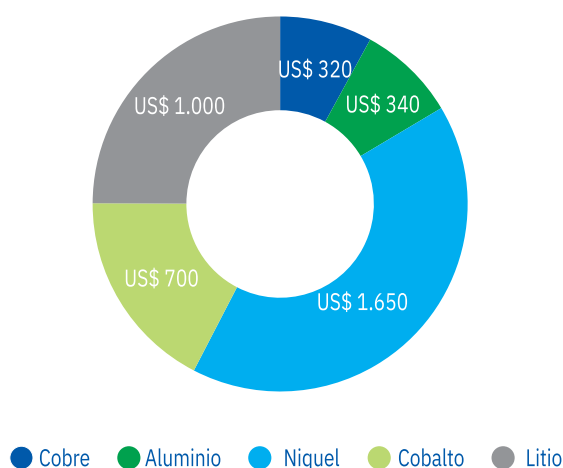
Figura 13. Participación de cada materia prima en el costo total de una batería EV con capacidad promedio de 64 kWh
